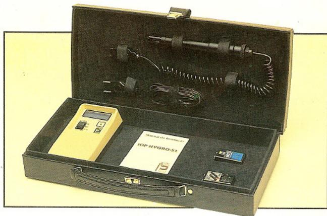
*Este instrumento portátil tem como função medir instantaneamente e de maneira prática a umidade relativa do ar e a temperatura ambiente, utilizando sondas dimensionadas para as mais diversas aplicações, sendo estas intercambiáveis entre si.*
